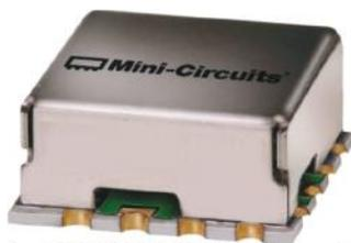
図5：モデルROS-4608CH-2 +は、4608 MHzの固定周波数出力を備えた表面実装VCOで、0.9~4.35 Vの制御電圧範囲で6 MHz / Vの標準的なチューニング感度を持つ
