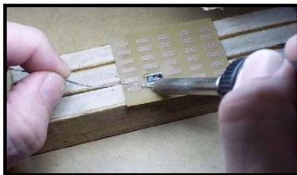
図 1: 手作業のはんだ付け
